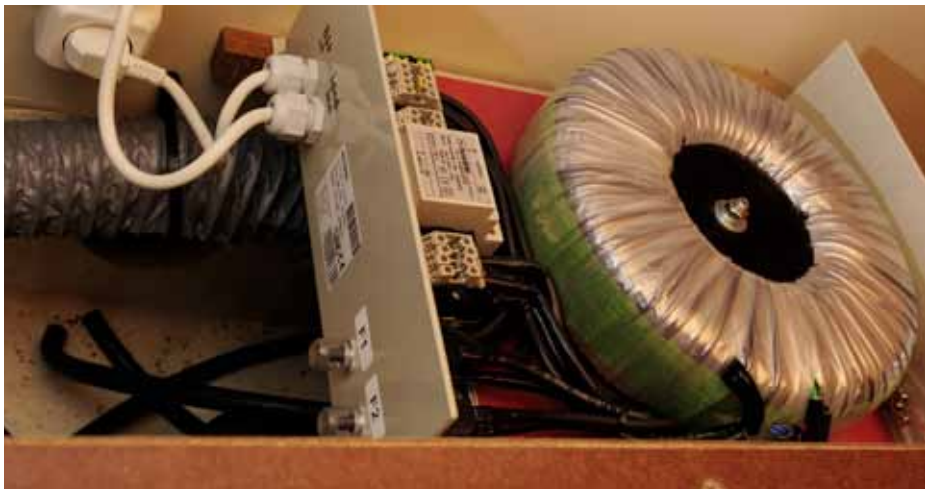
Så här ser innandömet i en ringkärnad skiljetransformator ut.
